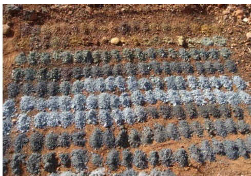
Mit den Bohrproben wurde eine geochemische Datenbank erstellt und die geförderten Gesteinssplitter können auf Lithium, sowie entsprechende Indikatorminerale untersucht werden.
