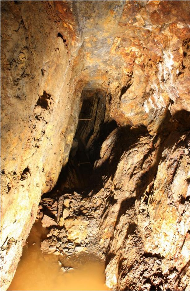
Abb. 6 1. Sohle der Goldgrube Görlitz, etwa 30 m westlich des 1. Gesenks, Blick nach W. Deutlich sind noch nicht beräumte Verbruchmassen und die Neigung des Stollens nach Süden (links) zu erkennen. An der rechten Stoßseite treten weiße Calcitsinterfahnen auf.
