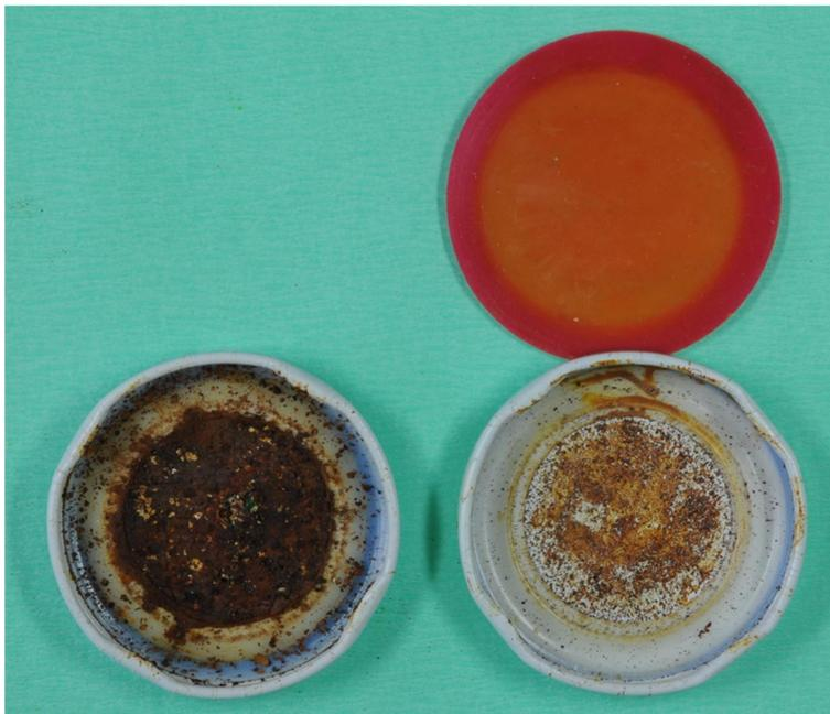
Rechts: Milchflaschendeckel (TO-48) mit schwerem Korrosionsschaden. Der Deckel ist durchgerostet. Links: eine 1 mm dicke Silikondichtung und der Milchflaschendeckel in dem diese verwendet wurde. Das ClO<sub>2</sub> hat das Silikon etwas gebleicht und es ist durch das Silikon und die Farbbeschichtung des Deckel diffundiert und hat zu Korrosionsschäden geführt.
