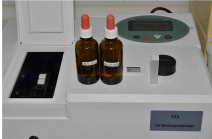
Mein Gerät habe ich per Alibaba in China gekauft. Einschließlich Fracht und Zoll hat es etwa 300 Euro gekostet. Der Hersteller hat die nötigen Messküvetten automatisch mitgeliefert. Die Messung der ClO<sub>2</sub>-Konzentration erfolgt am Besten bei eine Wellenlänge von 360 nm, da die Lichtabsorbtion von ClO<sub>2</sub> bei dieser Wellenlänge am größten ist.
