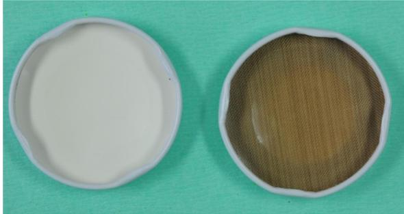
Links Deckeldichtung aus PE (Ettikett vom Type Zweckform L7914), rechts Deckeldichtung aus einseitig klebender, gewebeverstärkter Teflonfolie
