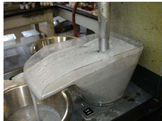
Test mit PV-Material in einer Ein-Liter-Flotationszelle
