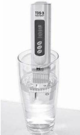
Ein [TDS-Meter](#) (links im Bild) gibt schnell Auskunft über die Gesamtbelastung des Wassers (zum Beispiel Salze, Chemikalien, Pestizide, Schwermetalle usw.). Es wird angezeigt, wie viele gelöste Stoffe im Wasser vorhanden sind. Messbar sind nicht die einzelnen Stoffe, sondern die Gesamtbelastung mittels ppm (parts per million).
