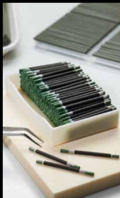
Jedes dieser 3 mm starken Keramikröhrchen (Solid Oxide Fuel Cells) produziert mit herkömmlichem Camping- oder Feuerzeuggas dauerhaft 1 Watt mit einem elektrischen Wirkungsgrad von über 60 %.
